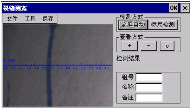
图 2-9 “手动测量”检测方式
